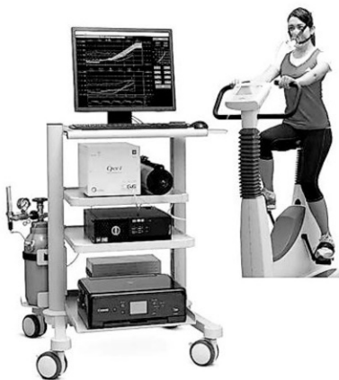
心肺運動負荷試験CPXのための呼気ガス分析装置(左)と自転車エルゴメーター
